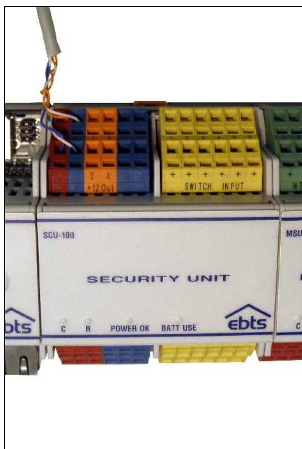
Kuva 19: Käyttöpaneelin kytkentä turvayksikköön SCU-100
